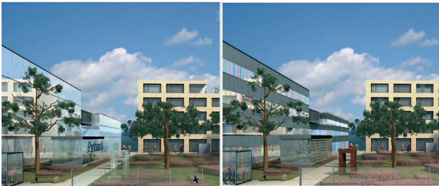
Obr. 12: Vlevo pro ptáky nebezpečné prostředí a vpravo stejné místo s minimem kolizních míst (City of Toronto 2011).
